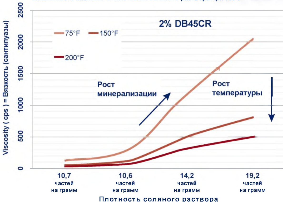
Зависимость вязкости от плотности соляного раствора при 100 с -1
